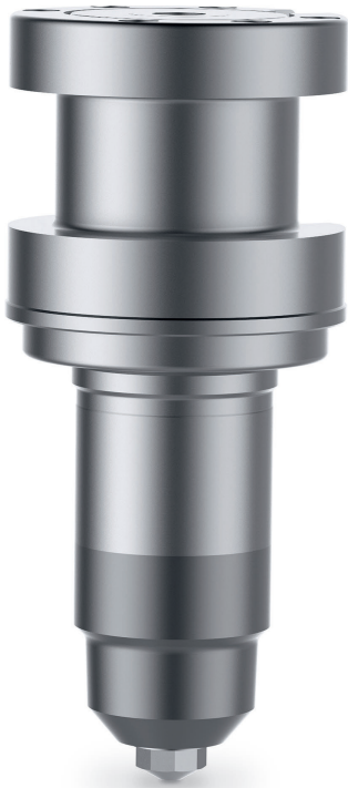
Systemdüse: Nadelverschlussdüse 6NHF mit KA-Nadelführung mit BlueFlow-Heizung und zweigeteiltem Schaft © Günther
